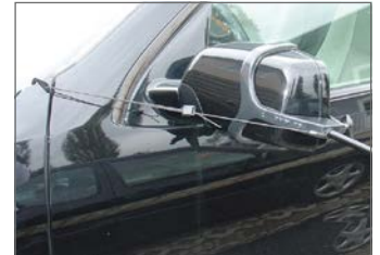
EMUK Halteleine Halteleine schwarz (1 Paar) Für Spiegelgehäuse. Verwendbar bei Gehäusen, die einen sehr geringen Einklappwiderstand haben. 200005 136/864
